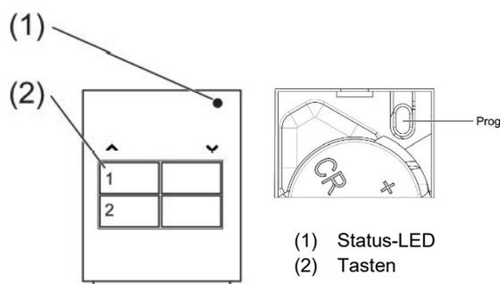
Abb. 4: Funk Sender (Vorderseite und Rückseite Innen)
