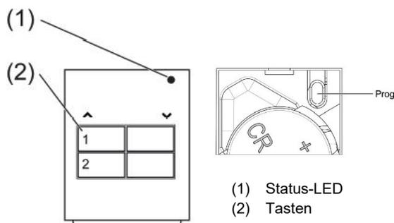
Abb. 3: Funk Sender (Vorderseite und Rückseite Innen)
