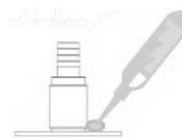
3. Um die Dichtheit zwischen Scheinwerfer und Einbauflansch zu gewährleisten müssen beide O-Ringe auf der Steckbefestigung des Scheinwerfers im Einbauflansch satt einrasten und gleichzeitig der Scheinwerfer an der Beckenwand anliegen. (O-Ringe müssen mit Silikonfett eingefettet werden und dürfen im beschädigten Zustand nicht mehr verwendet werden)
